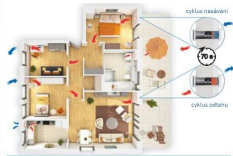
Větrací systém pracuje na principu zpětného zisku tepla pomocí reverzního ventilátoru pomocí změny směru otáčení ventilátorů. Integrovaný keramický výměník je nahříván teplým odpadním vzduchem, který proudí ven z objektu (cyklus odtahu). Po 70 sekundách obrátí reverzní ventilátor Xenion® chod svých otáček. Po této změně je venkovní vzduch nasáván do vnitřních prostorů a ohříván nashromážděným teplem z keramického výměníku (cyklus nasávání).
