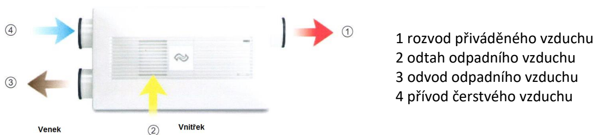
Obr.4: průtoky vzduchu v inVENTeru® PAX
